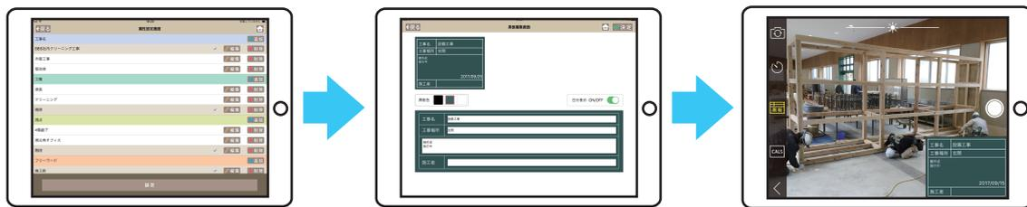
工事名、工種、測点、フリーワードを選択し写真の撮影します。撮影時に工事黒板を写しこみます。選択された項目で写真の振り分けを行います。
